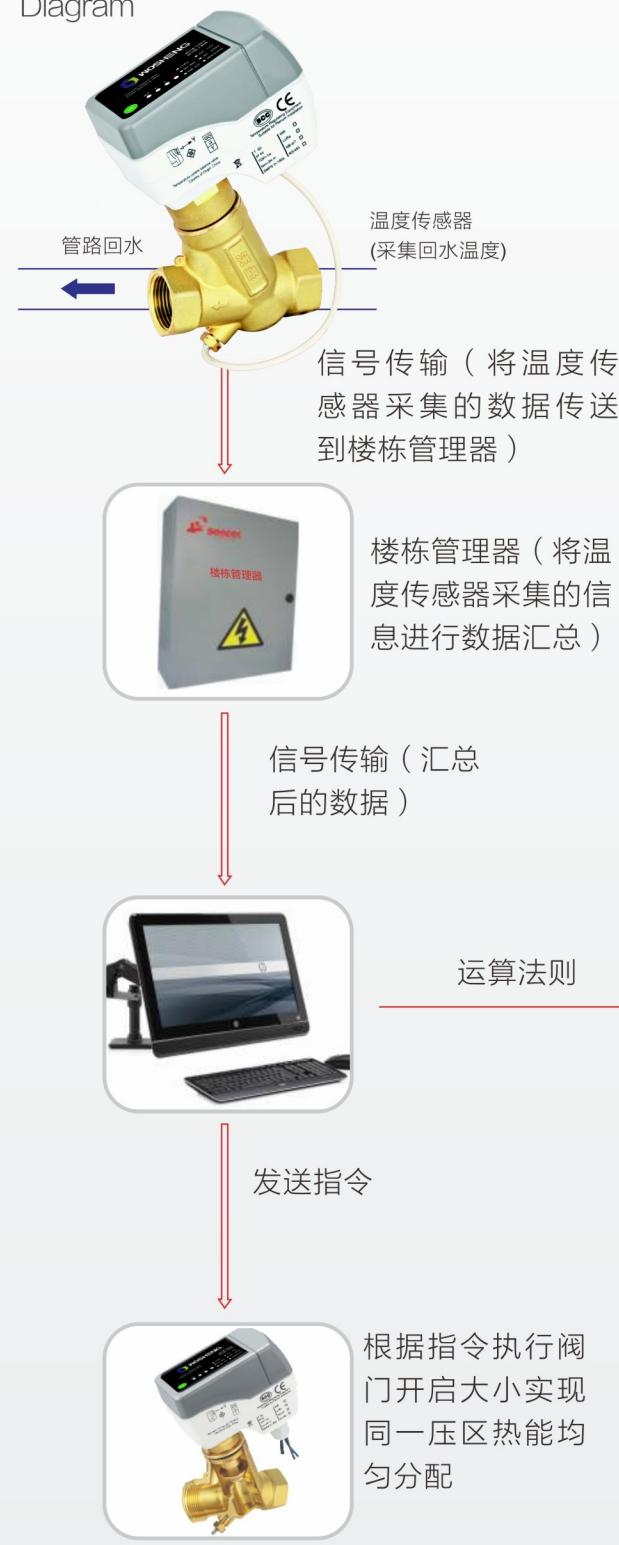
产品集成回水温度检测功能，同时可根据控制中心下达的供回水温差指令进行调节；通过精准调控回水温度（±0.5内），实现每户用热的均匀分配。
